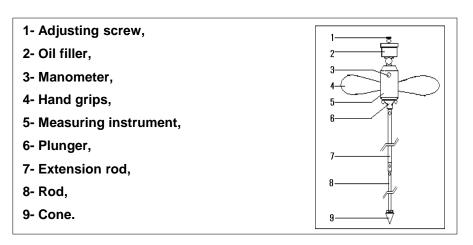
Fig. 1: Hand Penetrometer
