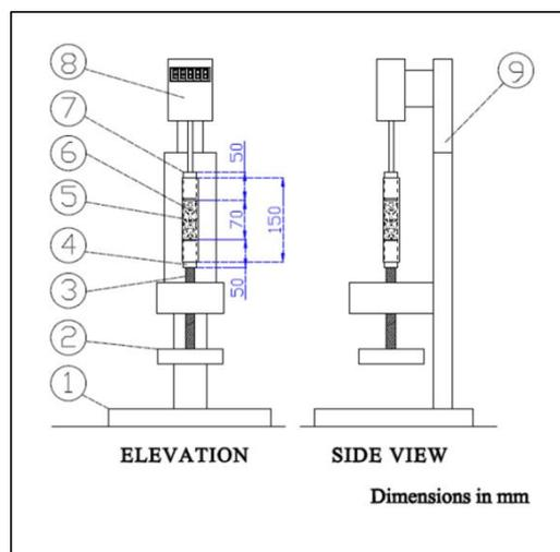
1)Base ;2) Pressing wheel handle ;3)Threading shaft ;4)Lower piston;5)Metallic mold/die;6) Raw material of prequating; 7)Upper piston; 8)Press digital gage; 9)Rear frame.
