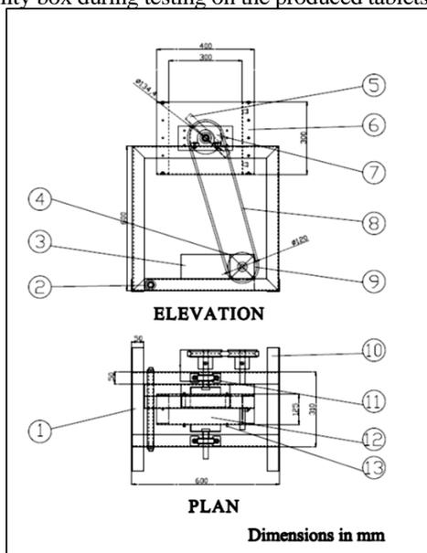
1)The chassis ;2) Electrical motor articulated point ;3) Electrical motor ;4)Gear box ;5)Baffle;6)Feeding gate;7)Driven pulley ;8)Belt ;9)Drive pulley ;10)Support leg;11)bearing;12) Durability box;13)Rivets.
