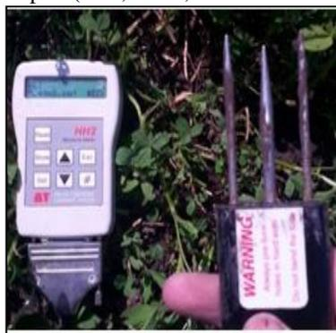
**Fig. 1. Time Domain Reflect meter (TDR).**
